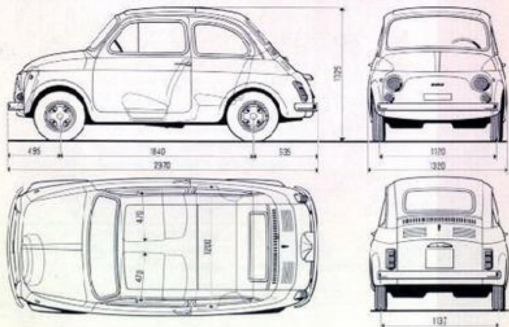
L'altezza massima s'intende a vettura scarica. - Volume vano bagagli anteriore: 30 dm<sup>3</sup>.
