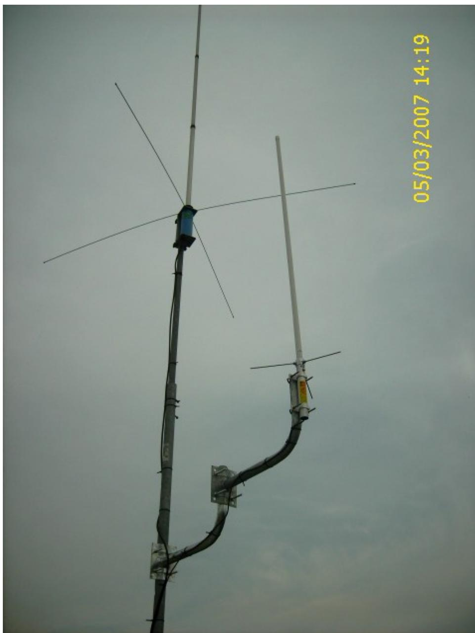
***Foto N.3, la “DIAMOND X50” sul palo “in compagnia” della WEGA 27 antenna ½ onda in 11mt.***
