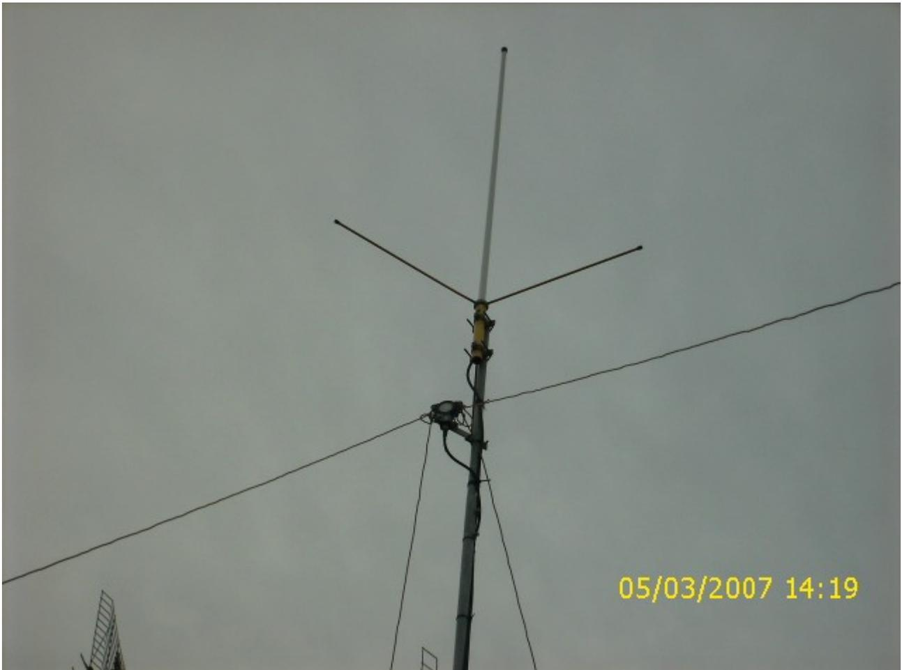
*Foto: antenna bi-banda con sotto balun 1:6 da dove partono i quattro rami del dipolo...*
