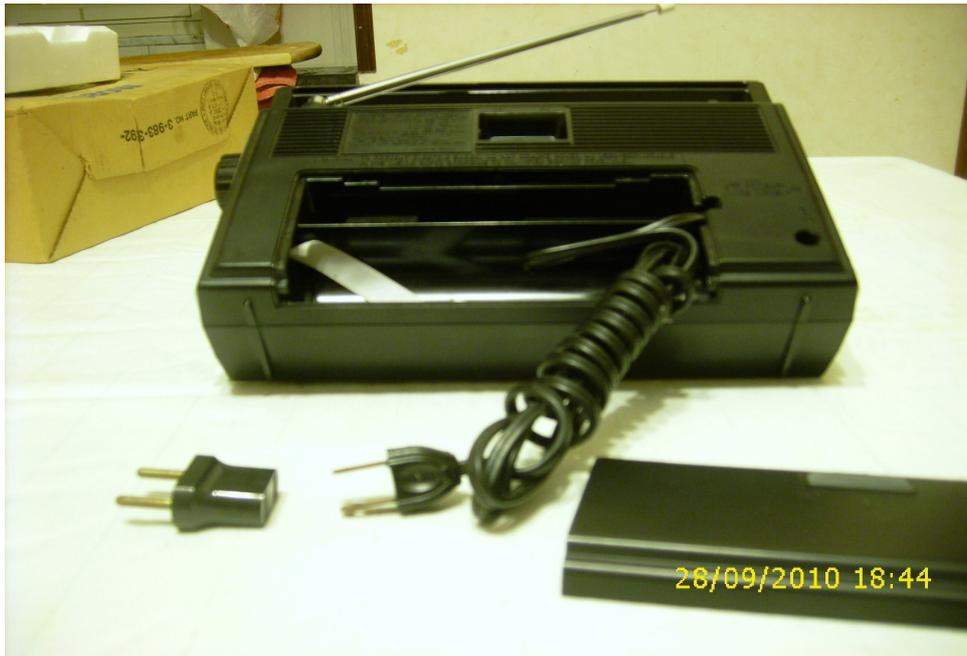
*La parte posteriore: Particolare del cordone di alimentazione rete 220V. Stranamente, si può notare una spina con attacco tipo U.S.A. ma era fornito anche l'adattatore per attacco Europeo*
